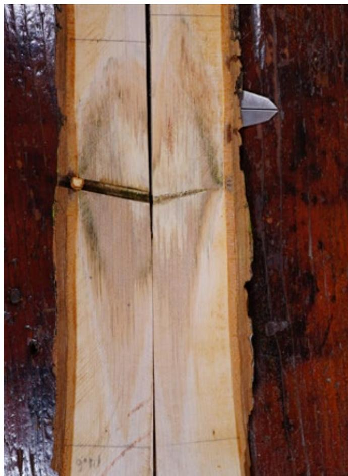
Figure 2 : Coupe longitudinale d'une blessure d'entaille de 4 cm de profond (1,57 po).
