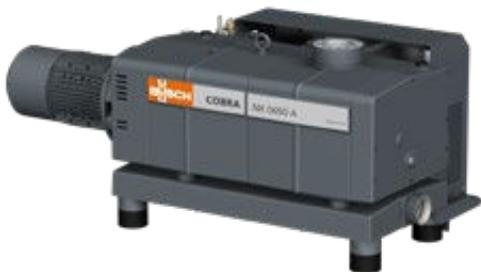
La pompe COBRA NC est une pompe à vide, double vis, mono-étagée. Deux rotors à vis sont mis en rotation à l'intérieur du cylindre. Le gaz est aspiré par les vis, compressé et transporté à l'échappement de la pompe. Ce processus s'effectue sans contact entre les vis et le corps de pompe. Le refroidissement s'effectue, soit via un système air/liquide avec un radiateur en circuit fermé ou soit par un système à l'eau ou glycol, avec un apport d'eau externe.
