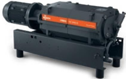
La pompe COBRA NC est une pompe à vide, double vis, mono-étagée. Deux rotors à vis sont mis en rotation à l'intérieur du cylindre. Le gaz est aspiré par les vis, compressé et transporté à l'échappement de la pompe. Ce processus s'effectue sans contact entre les vis et le corps de pompe. Le refroidissement s'effectue, soit via un système air/liquide avec un radiateur en circuit fermé ou soit par un système à l'eau ou glycol, avec un apport d'eau externe.
