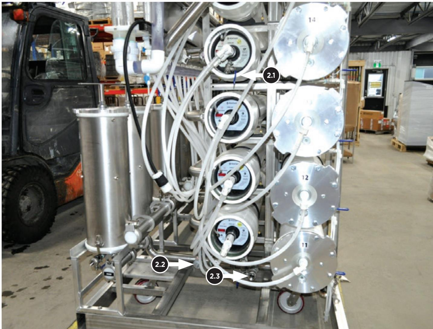
2.1 Valve de drainage du caisson et de ses caissons supérieurs.
