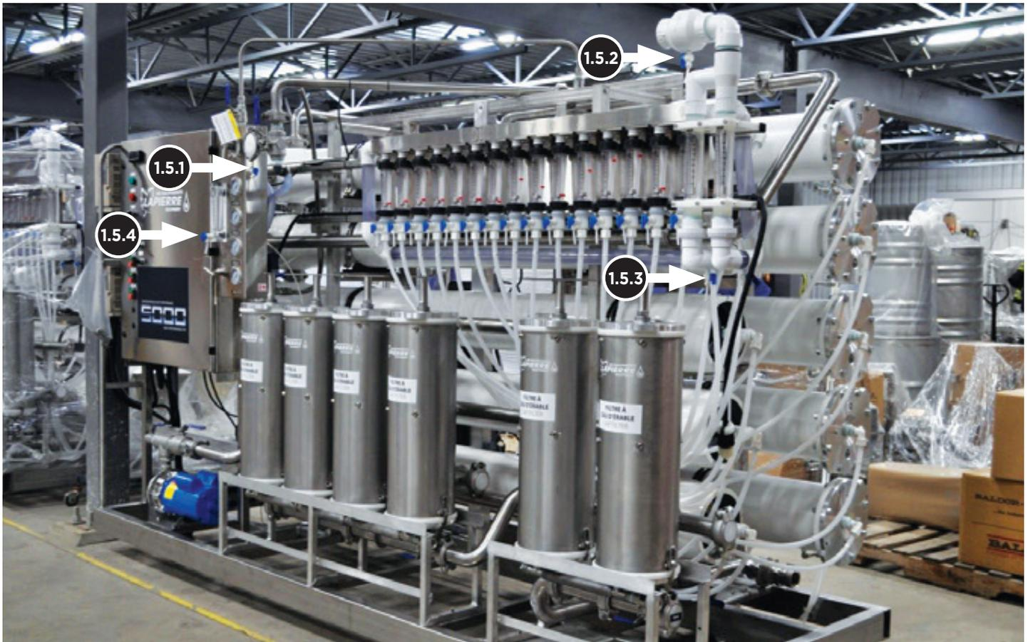
1.5 Valves d'échantillonnage pour la collecte de l'eau concentrée afin d'évaluer le degré Brix (1.5.3 et 4) ainsi que les valves de drainage (1.5.1, 2 et 3).
