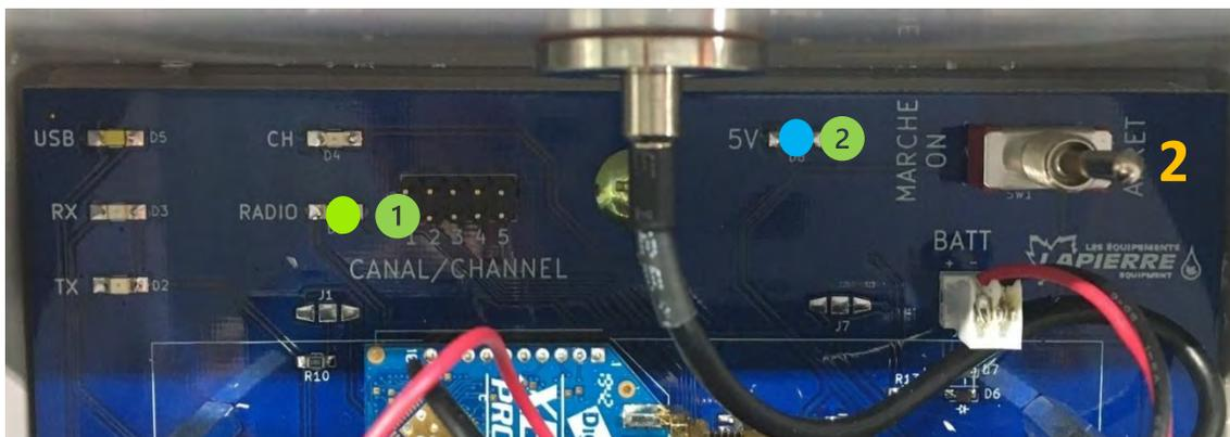
Figure 83 : Témoins lumineux DEL radios de la base DATACER
