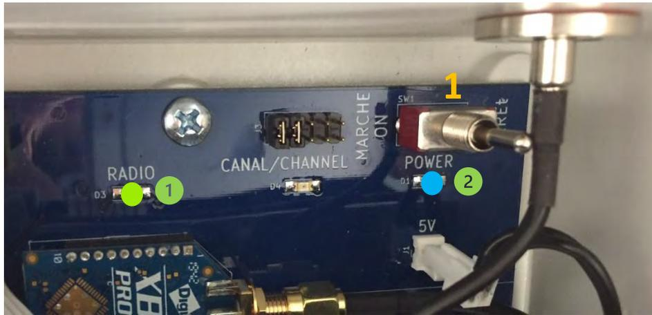
Figure 84 : Témoins lumineux DEL radio station DATACER
