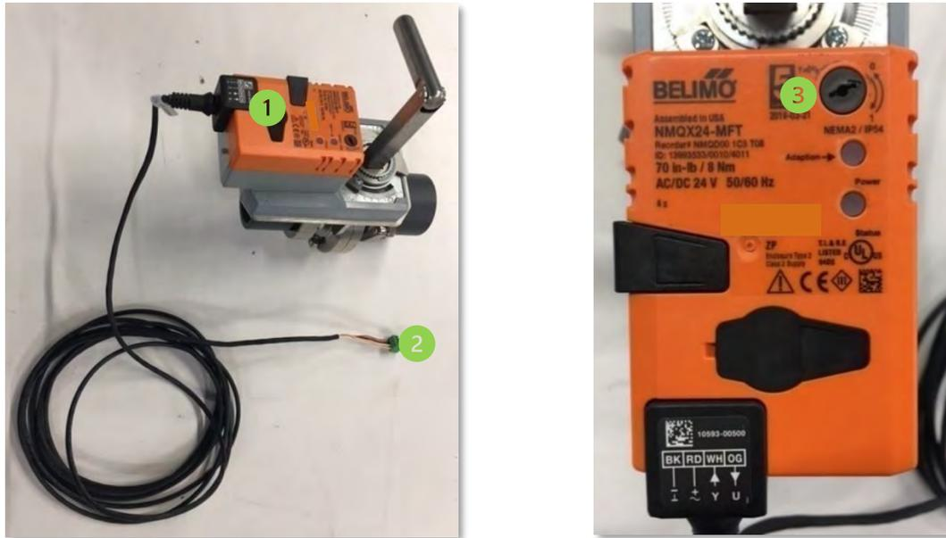
Figure 9 : Valve de modulation du niveau de vacuum
