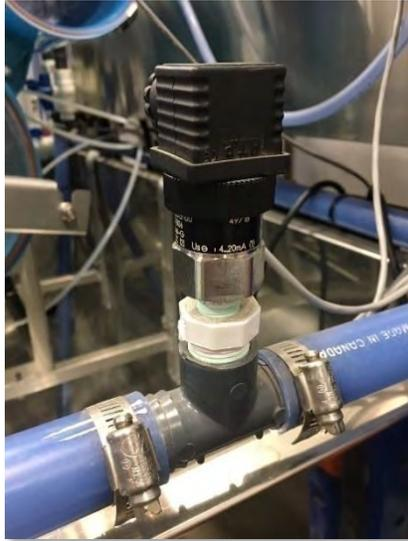
Figure 50 : Capteur de pression vissé installé
