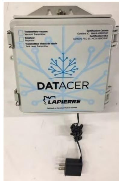
Figure 22 : Répéteur branché sans antenne connexion N femelle
