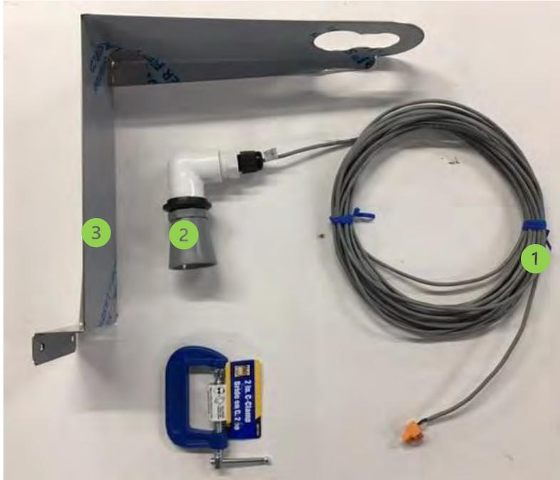
Figure 18 : Capteur sonar pour station DATACER
