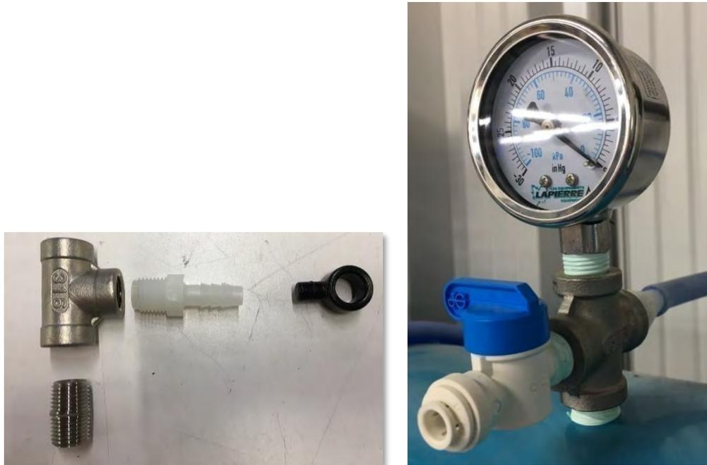
Figure 55 : Branchement du tuyau 5/16 po (7,94 mm) à l'extracteur
