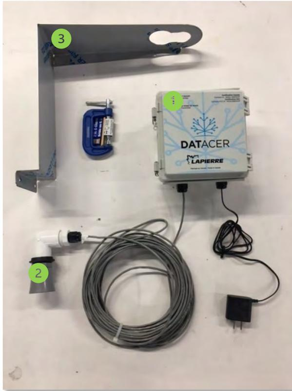
Figure 4 : Transmetteur de niveau de bassin par sonar (L)
