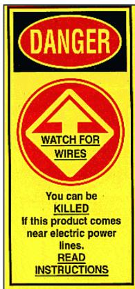
Cette étiquette d'avertissement doit être apposée sur l'antenne, de manière bien visible pour les installateurs et le personnel de maintenance. S'il n'y a pas de place sur l'antenne, il est recommandé d'apposer l'étiquette sur un support de montage ou un emplacement de montage (un mât, par exemple) situé près de l'antenne.
