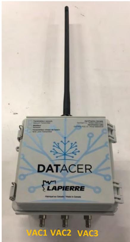
Figure 86 : Signification des mesures de niveau de vacuum sur l'interface (VAC1, VAC 2 et VAC 3) par rapport à la position des ports vacuum sur un transmetteur
