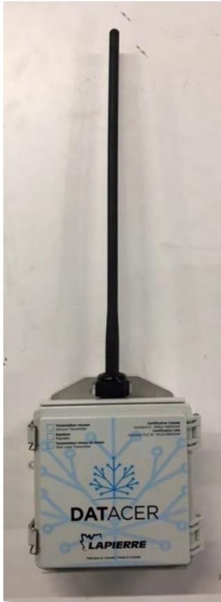
Figure 20 : Répéteur à piles avec antenne fouet omnidirectionnelle
