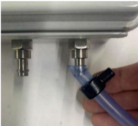
Figure 44 : Coupe du tuyau 5/16 po (7,94 mm) en biseau pour faciliter l'installation et la désinstallation sur le port vacuum du transmetteur.
