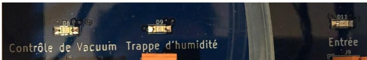
D6 | Contrôle de vacuum : Si allumée, la pompe vacuum est alors en fonction.
