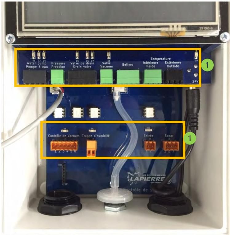
1 Connexions pour brancher les capteurs et outils périphériques.
