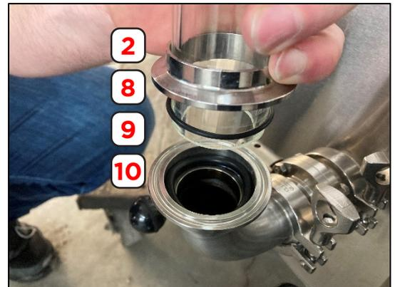
Manipuler avec soin le tube de verre et insérer en premier le joint torique #325 (épais) dans le fond et ensuite le joint torique # 132 (mince) autour du tube de verre (voir photo ci-dessus). Après avoir déposé le tube, fixer le support du tube de verre sur le réservoir à l'aide de la vis mécanique 10-24 x 1/2".
