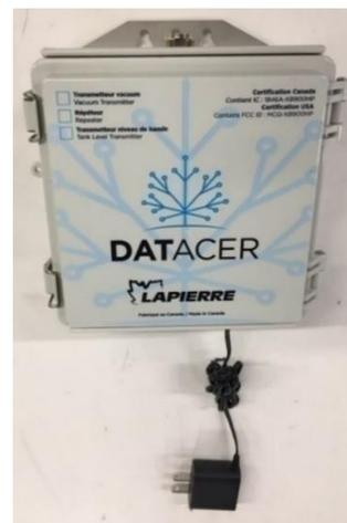
Figure 27: Répéteur branché sans antenne connexion N femelle
