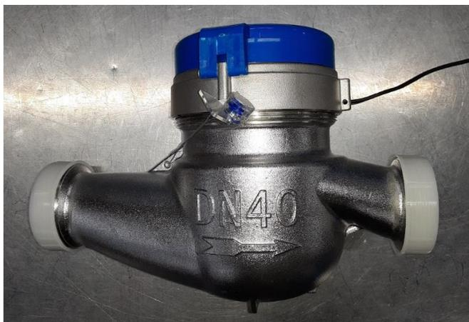
Figure 16: Compteur d'eau d'érable DATACER vue de profil
