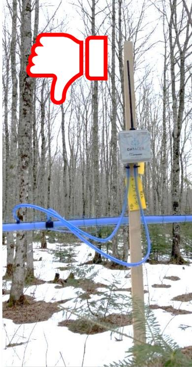
Figure 47 : Transmetteur vacuum mal installé
