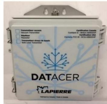
Figure 26 : Répéteur à piles sans antenne connexion N femelle
