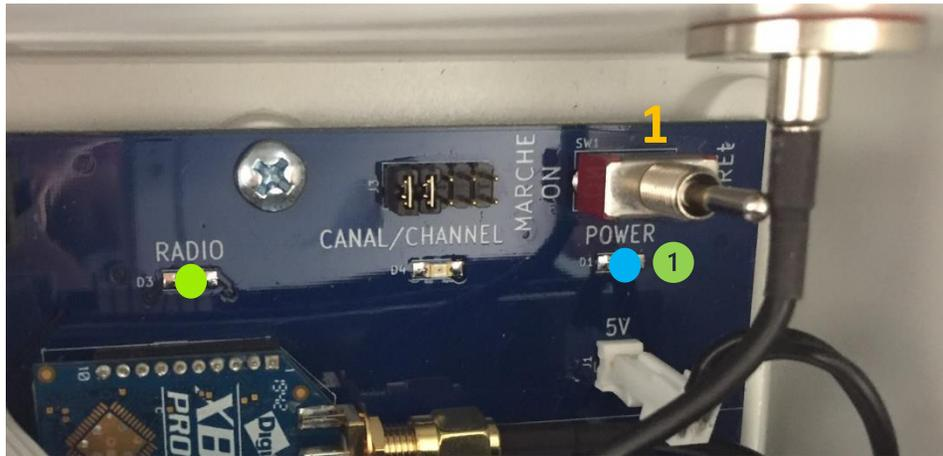
Figure 126 : Témoins lumineux DEL radio station DATACER
