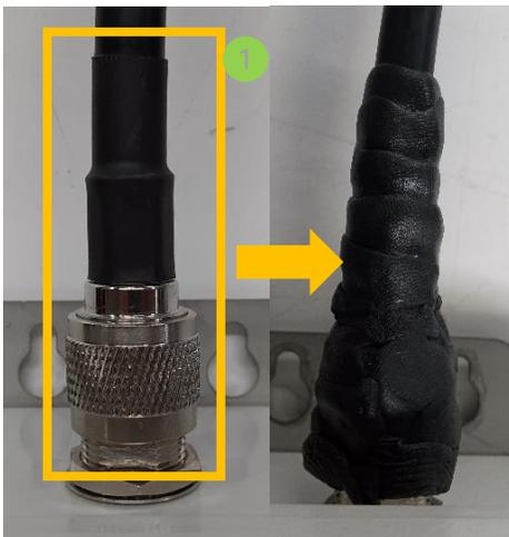
*Figure 122 : Coax-seal côté transmetteur*
