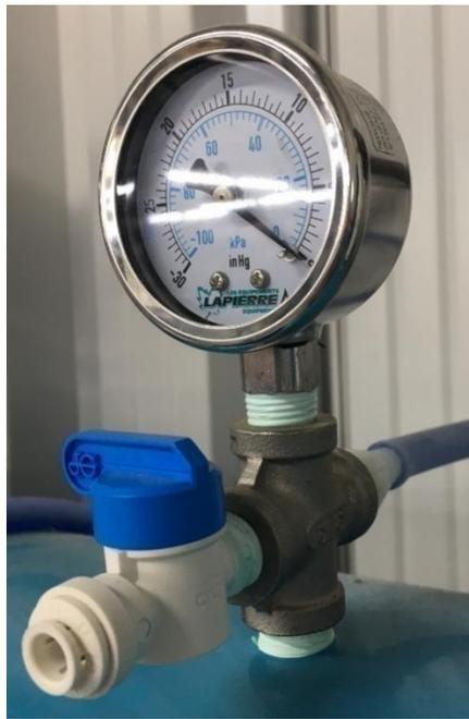
Figure 74 : Branchement du tuyau 5/16 po (7,94 mm) à l'extracteur
