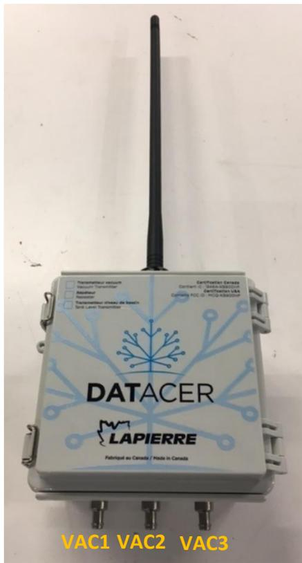
Figure 128 : Signification des mesures de niveau de vacuum sur l'interface (VAC1, VAC 2 et VAC 3) par rapport à la position des ports vacuum sur un transmetteur
