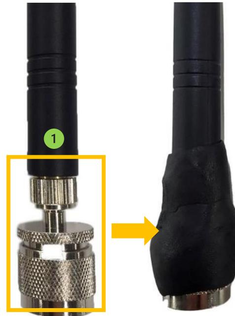
*Figure 121 : Coax-seal côté antenne option A***Côté transmetteur :**
