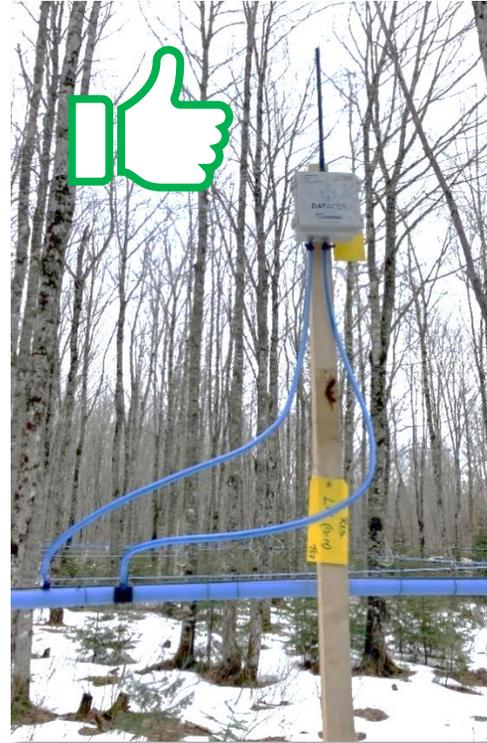
Figure 48 : Transmetteur vacuum bien installé
