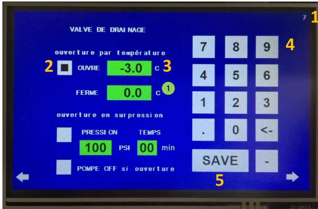
1 Laisser un écart d'au moins 2 °C ou 4 °F entre la température d'ouverture et la température de fermeture pour un bon fonctionnement.
