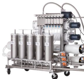
Ce design flexible permet de multiples configurations. Il peut accommoder des caissons membranes simples et/ou doubles, des unités de filtration, une pompe de suralimentation et même les débitmètres de chacune des membranes. La combinaison de caissons membranes simples et doubles, additionner d'une pompe de suralimentation permet une concentration plus élevée toute en conservant des performances exceptionnelles.
