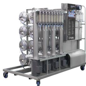
Plus compacte et nécessitant moins d'espace, notre version 2500/3500 est disponible avec les concentrateurs Séries 2000 et 3000. La disposition des caissons en inox à l'horizontal sur le support permet une manipulation rapide et plus facile des membranes en début et fin de saison.
