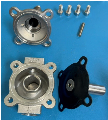
ILLUSTRATION 20 | Ensemble des pièces d'une valve électronique supplémentaire démontée
