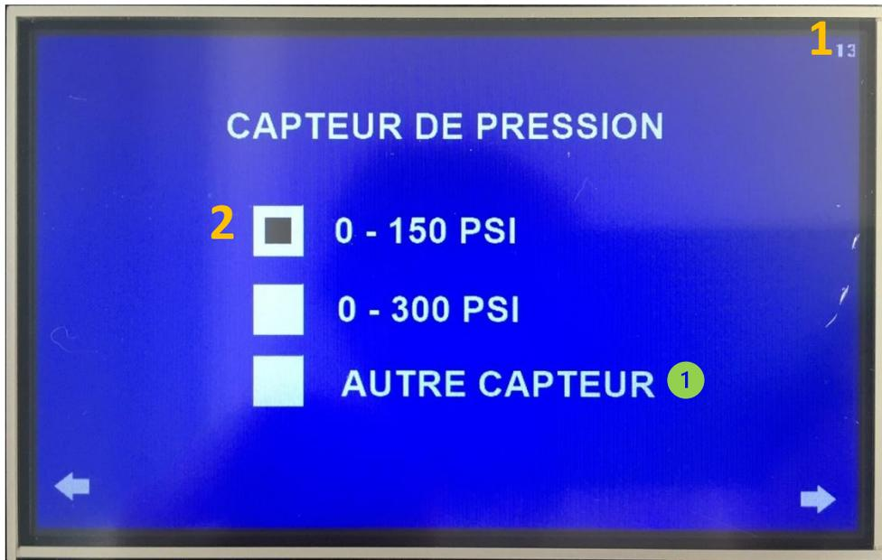
**1** Les capteurs de pression 0-150 et 0-300 PSI sont utilisés pour mesurer une pression de pompe à eau ou une pression à la sortie des préfiltres d'un concentrateur.
