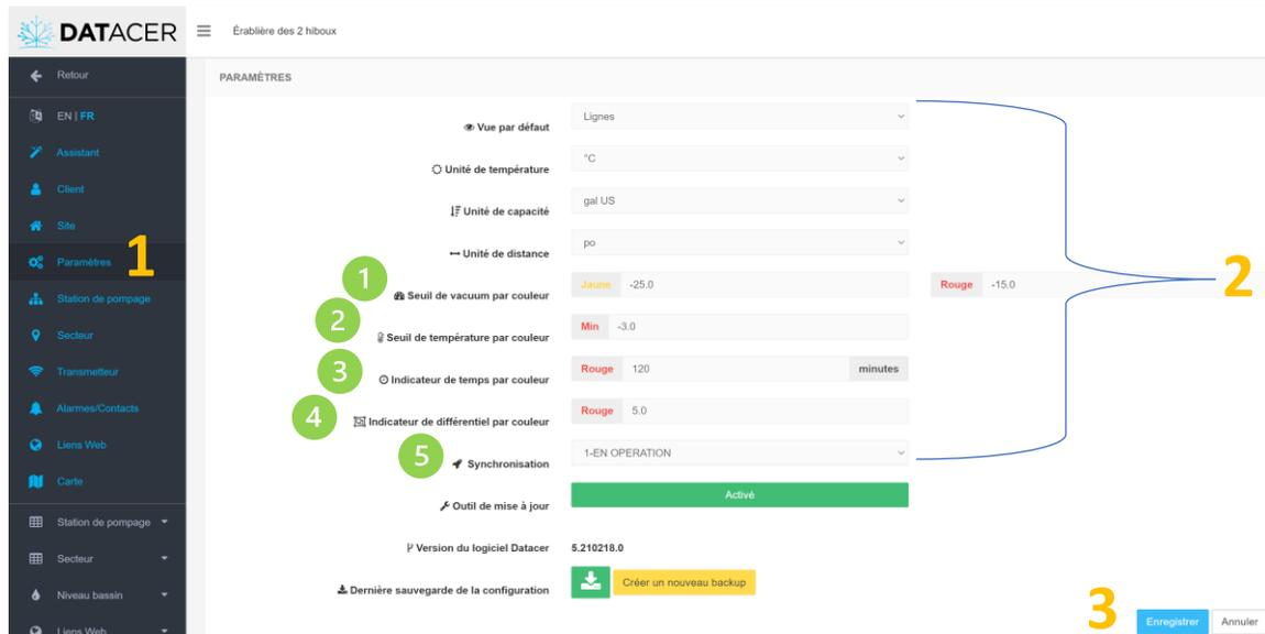
1 Si le niveau de vacuum est inférieur ou égal à -25 poHg (par exemple -26 poHg) alors la ou les cases concernées par le ou les capteurs s'affichent de couleur verte sur l'interface DATACER.
