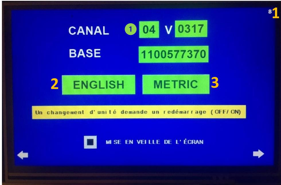
Figure 127: Visualiser le canal de la station DATACER
