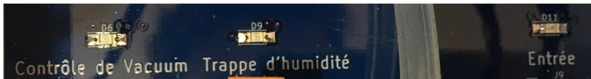
D6 | Contrôle de vacuum : Si allumée, la pompe vacuum est alors en fonction.
