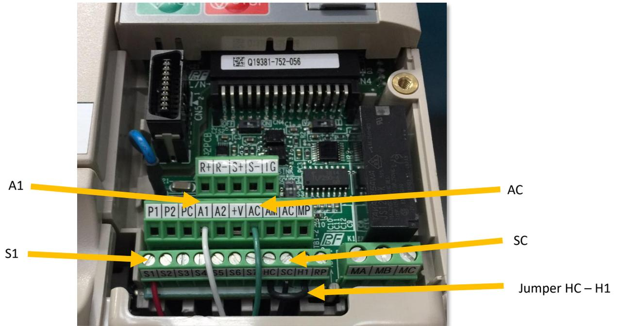
Figure 82 : Branchement d'un variateur de fréquence Yaskawa V1000
