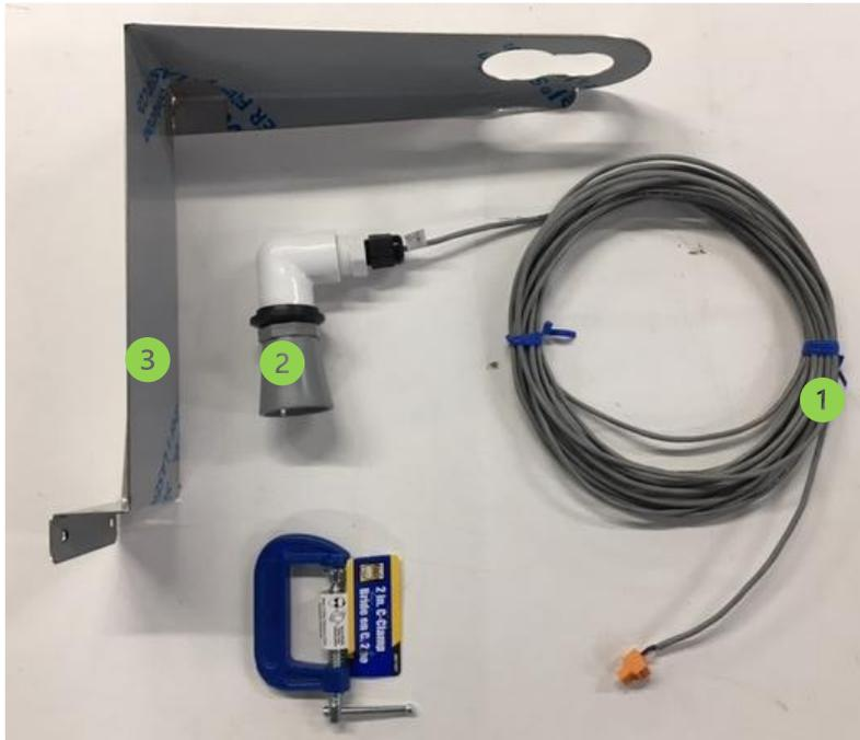
Figure 21 : Capteur ultrason pour station DATACER
