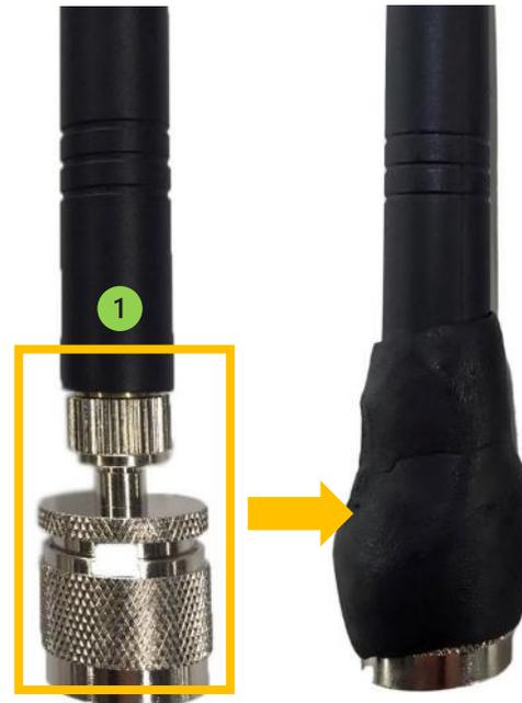
Figure 123 : Coax-seal côté antenne option A
