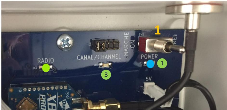
Figure 129 : Témoins lumineux DEL radio station DATACER
