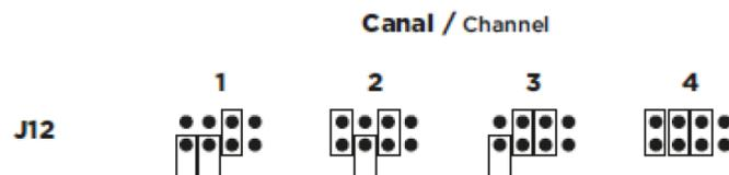
Figure 45 : Correspondance de la position des cavaliers sur les broches et numéro de canal d'un transmetteur
