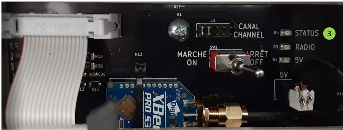
**3** Les clignotements rouges réguliers du témoin lumineux du canal (ou status à partir de la station DATACER version 1.8 voir ci-dessus) des stations DATACER avec une version de logiciel supérieure ou égale à 400, indique que le programme de la station est en état de marche.
