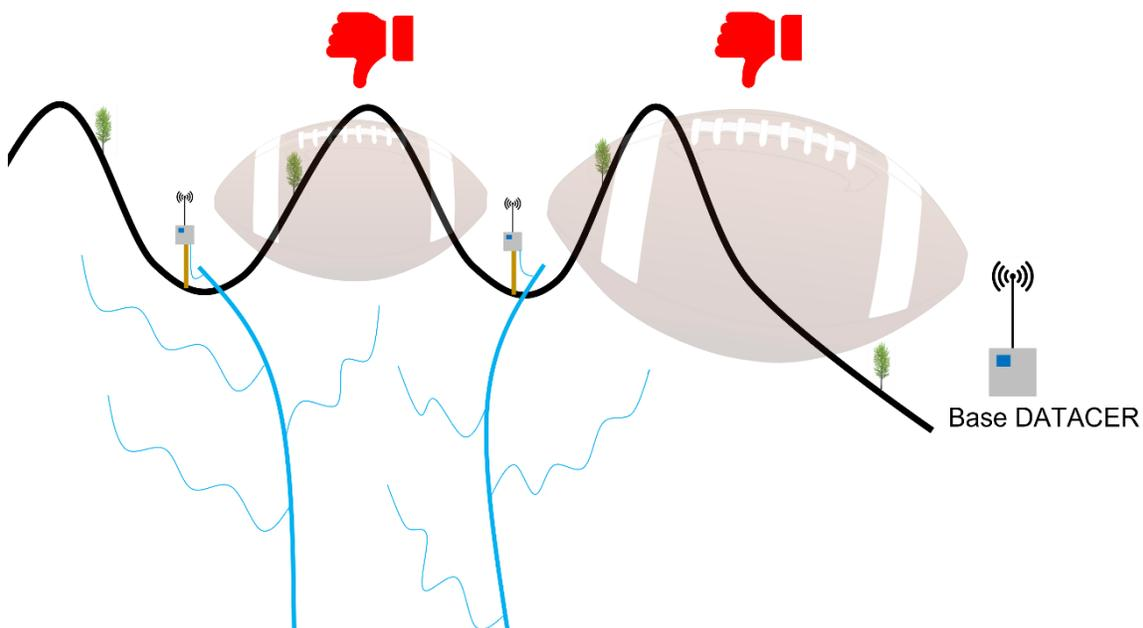
Figure 49 : Transmetteurs vacuums installés dans les zones basses
