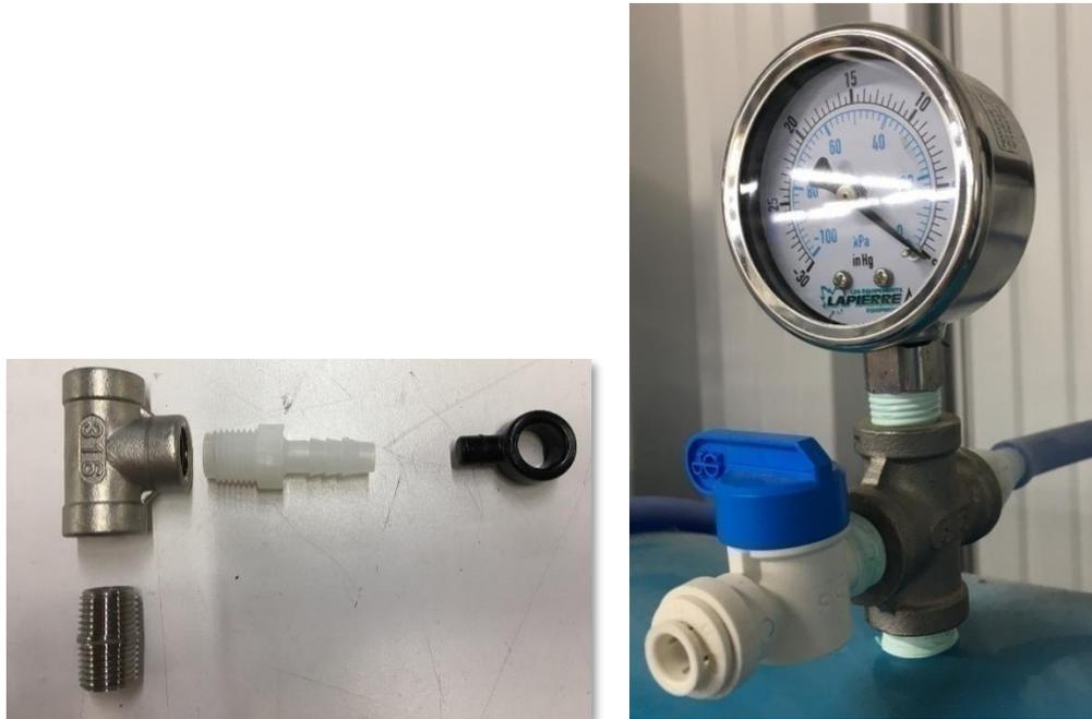
Figure 75 : Branchement du tuyau 5/16 po (7,94 mm) à l'extracteur
