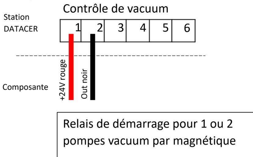
Figure 77 : Branchement du relais de démarrage de pompe vacuum dans la station DATACER
