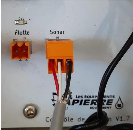
4. Brancher le compteur d'eau dans le module électronique
