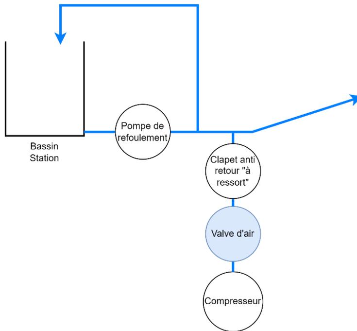
Figure 103 : Valve de prise d'air installée
