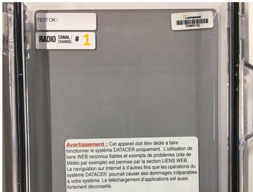
Figure 44 : Trouver son numéro de canal de base DATACER. Vue intérieure du couvercle de la base DATACER
