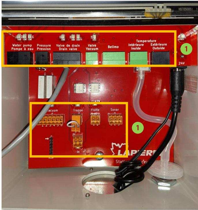
**1** Connexions pour brancher les capteurs et outils périphériques.
