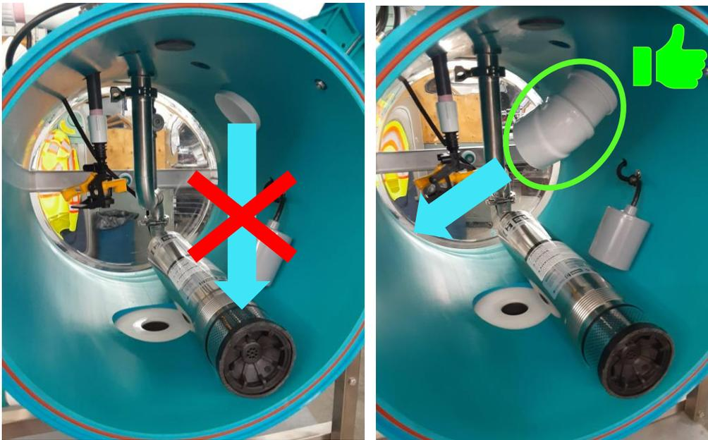
Figure 134: Installation d'un coude à l'intérieur de l'extracteur pour dévier l'arrivée d'eau d'étable pour réduire la formation de bulles d'air proche de l'aspiration de la pompe
