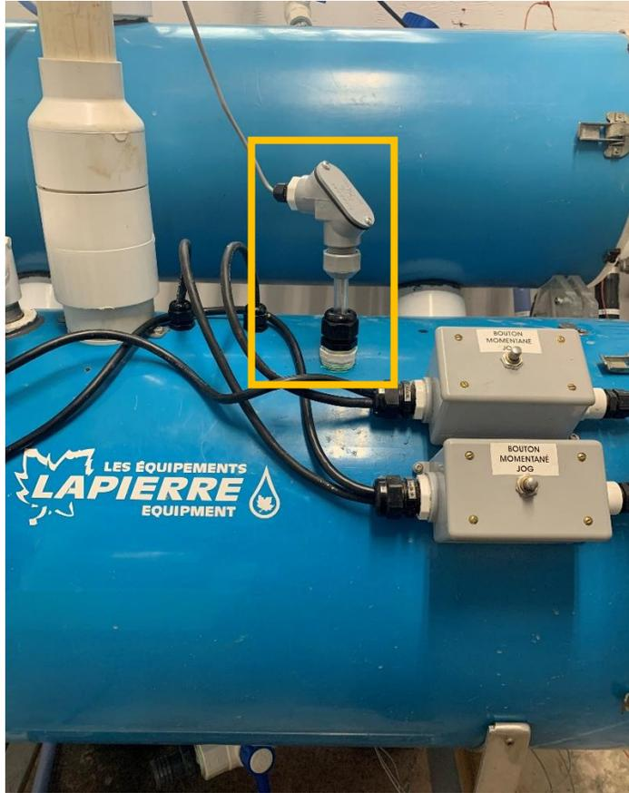
Figure 88 : Flotte pour arrêt d'urgence d'extracteur horizontal installée
