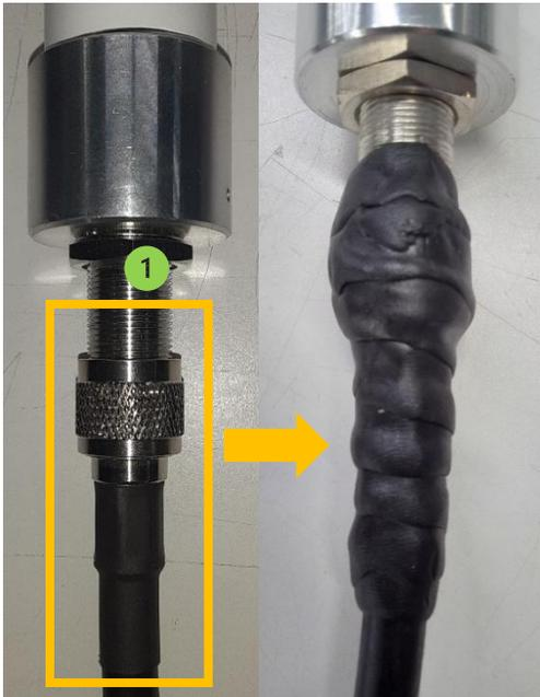
Figure 122 : Coax-seal côté antenne option B ou C
