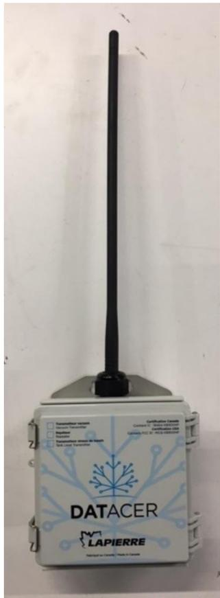
Figure 25 : Répéteur à piles avec antenne fouet omnidirectionnelle
