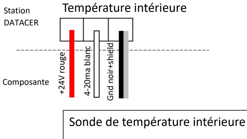
Figure 105 : Branchement de la sonde de température intérieure dans la station DATACER
