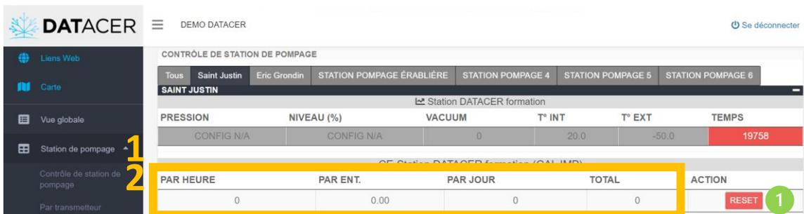
1 Le bouton « RESET » permet de remettre à 0 l'ensemble des données mesurées par le compteur d'eau soit les volumes/heure, /entaille, /jour et le volume total.
