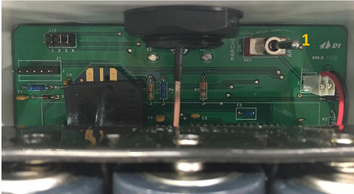
2. Enlever les batteries pour les transmetteurs non solaires ou débrancher les cordons électriques selon le type de transmetteur.
