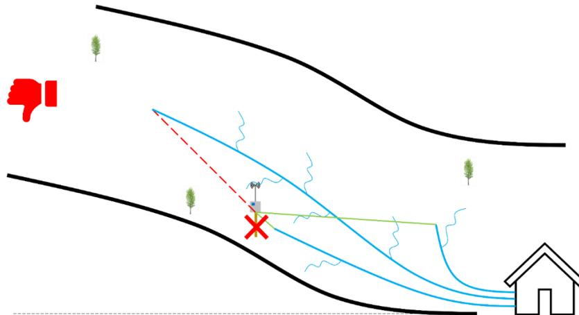
Figure 51 : Pente non respectée pour un des tuyaux 5/16 po reliés au transmetteur
