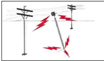
Assurez-vous qu'aucune ligne à haute tension ne se trouve dans le périmètre d'installation. Les antennes, les mâts, les tours, les cordes et les câbles d'hauban peuvent venir en appui ou entrer en contact avec les lignes à haute tension.
