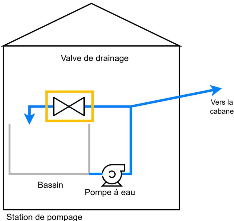
Figure 101 : Schéma d'installation d'une valve de drainage
