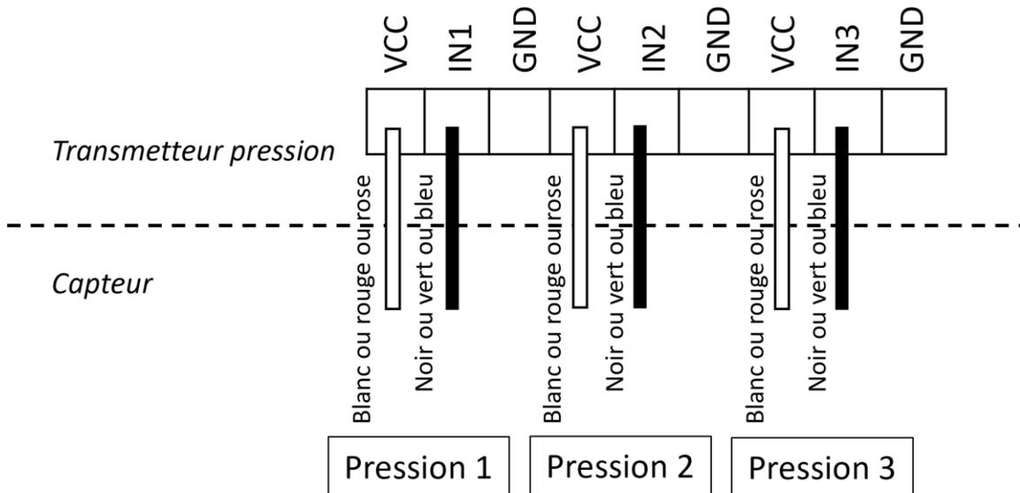
Figure 72 : Connexion des capteurs de pression pour un transmetteur de pression triple (PPP) – version 6
