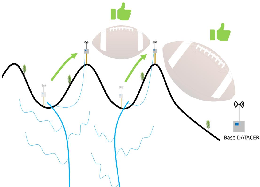
Figure 50 : Transmetteurs vacuums installés sur des points hauts
