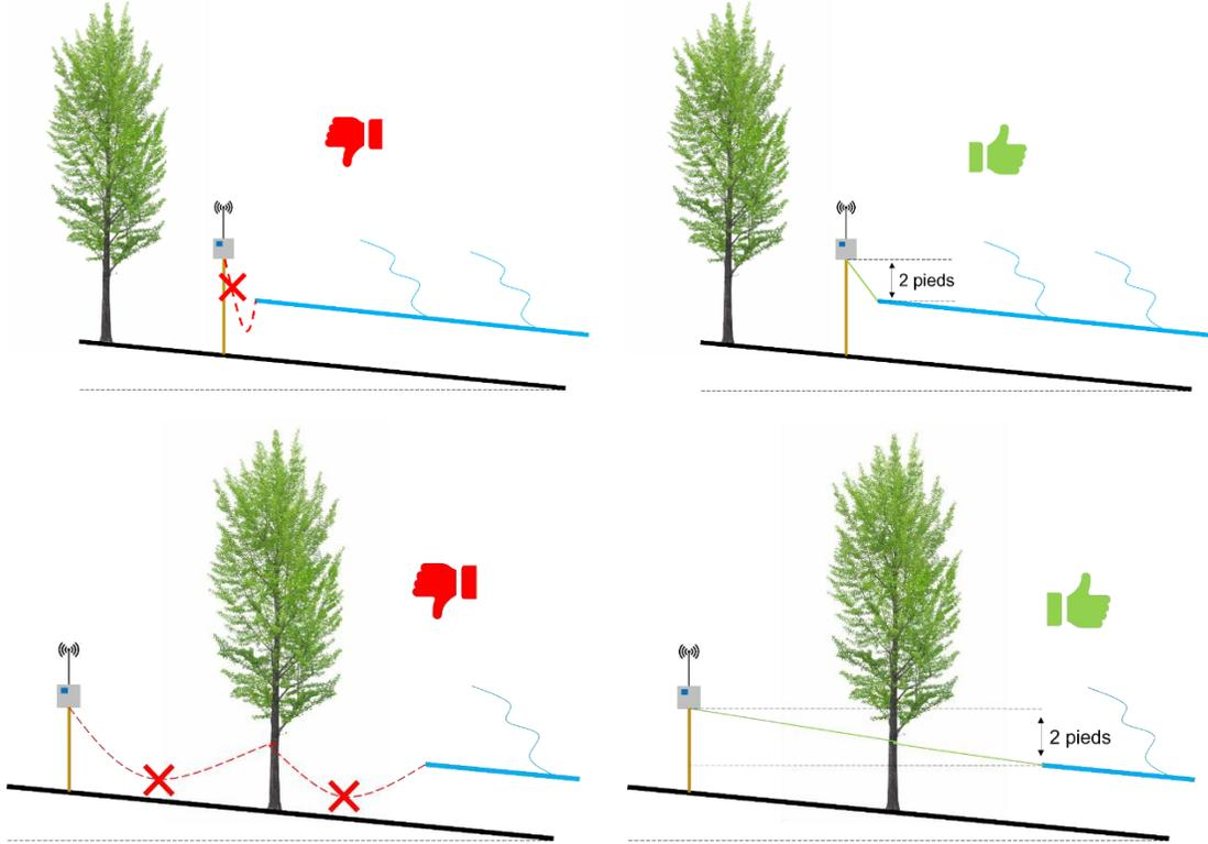
Figure 53 : Pente constante du tuyau 5/16 po (7,94 mm) non respectée
