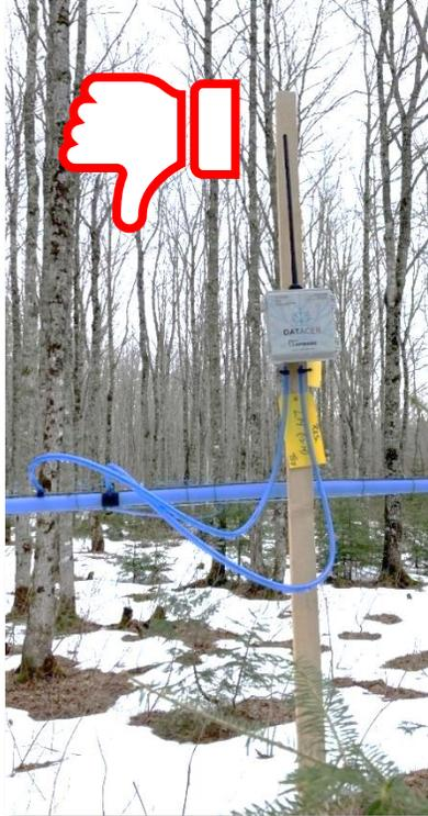
Figure 47 : Transmetteur vacuum mal installé
