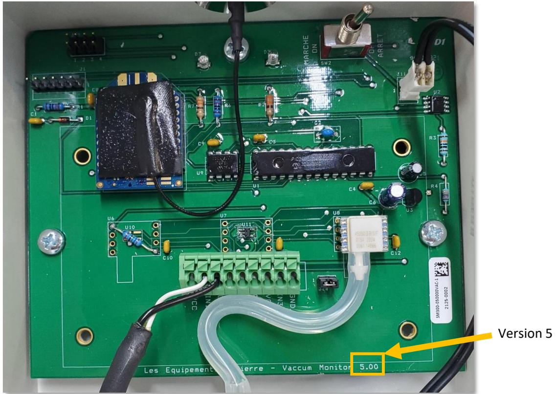
Figure 67 : Vue intérieure d'un transmetteur de pression simple (P) – version 5
