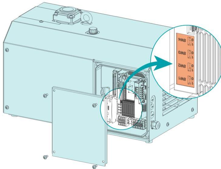
Figure 83 : Position des commutateurs (DIP) (switches) sur la pompe MVO40 (Bush)
