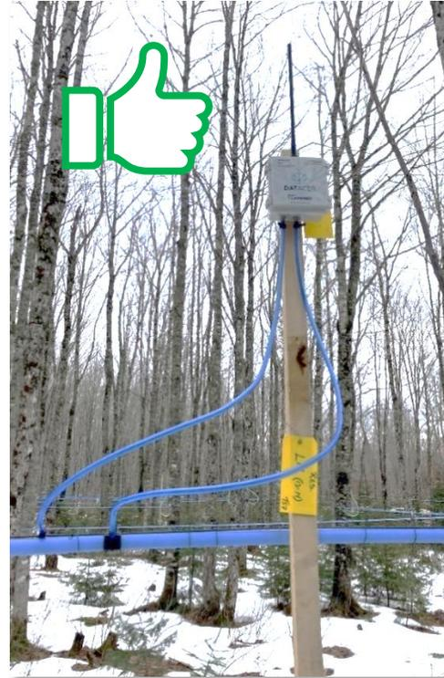
Figure 48 : Transmetteur vacuum bien installé
