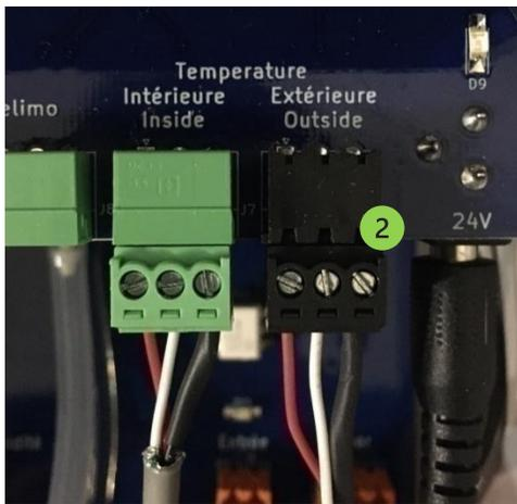
Figure 76 : Branchement d'un périphérique avec connecteur dans la station DATACER
