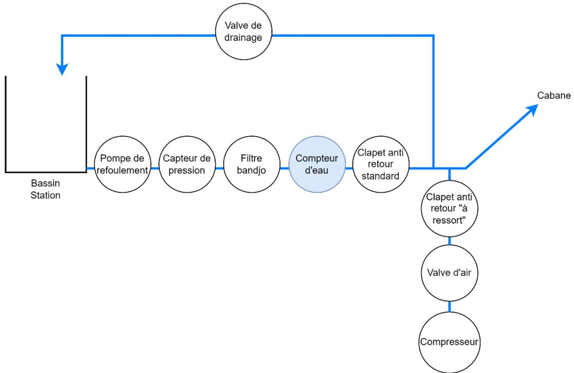
Figure 136: Installation d'un compteur d'eau dans une station de pompage sur la conduite de refoulement d'un bassin en présence de drainage
