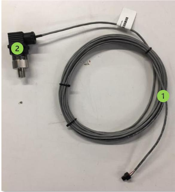
Figure 22 : Capteur de pression pour station DATACER
