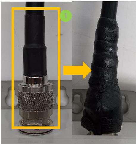
Figure 124 : Coax-seal côté transmetteur
