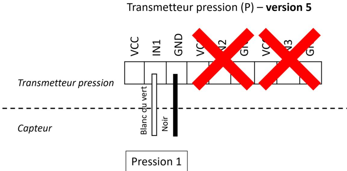
Figure 66 : Connexion du capteur de pression pour un transmetteur de pression simple (P) – version 5
