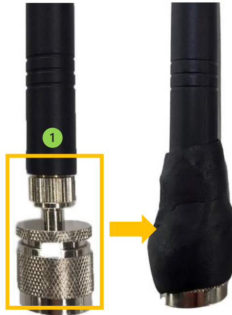
Figure 123 : Coax-seal côté antenne option A
