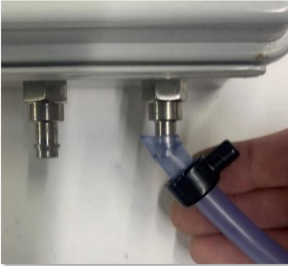
Figure 55 : Coupe du tuyau 5/16 po (7,94 mm) en biseau pour faciliter l'installation et la désinstallation sur le port vacuum du transmetteur.
