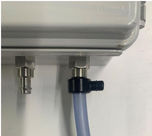
Figure 55 : Coupe du tuyau 5/16 po (7,94 mm) en biseau pour faciliter l'installation et la désinstallation sur le port vacuum du transmetteur.
