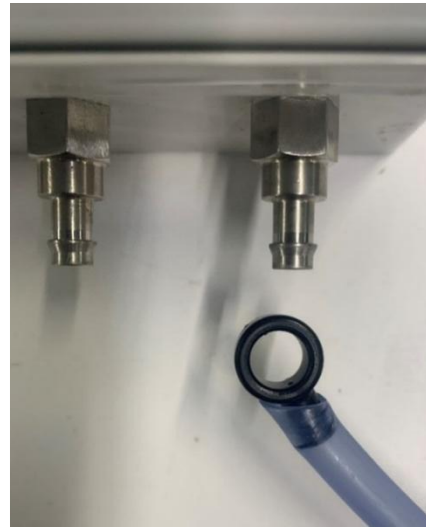
Figure 55 : Coupe du tuyau 5/16 po (7,94 mm) en biseau pour faciliter l'installation et la désinstallation sur le port vacuum du transmetteur.
