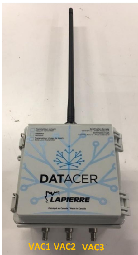
Figure 131 : Signification des mesures de niveau de vacuum sur l'interface (VAC1, VAC 2 et VAC 3) par rapport à la position des ports vacuum sur un transmetteur
